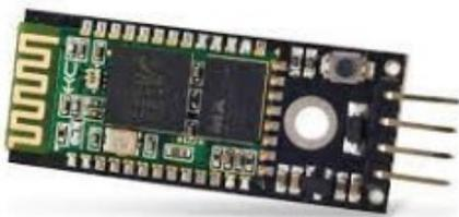
Le module Bluetooth HC-05 présente 6 broches pour permettre d'établir la connexion.
